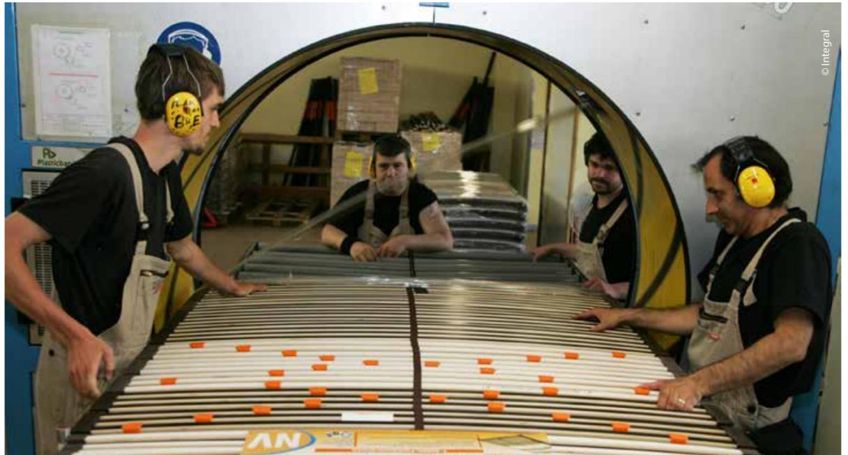
Mitarbeiter von Integral an der Stretchmaschine in der Lattenrahmenproduktion.
